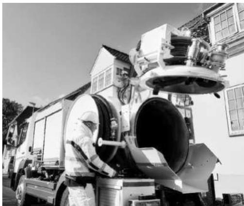
Le fond arrière s'ouvre hydrauliquement et permet l'évacuation des boues une fois l'intervention réalisée.
