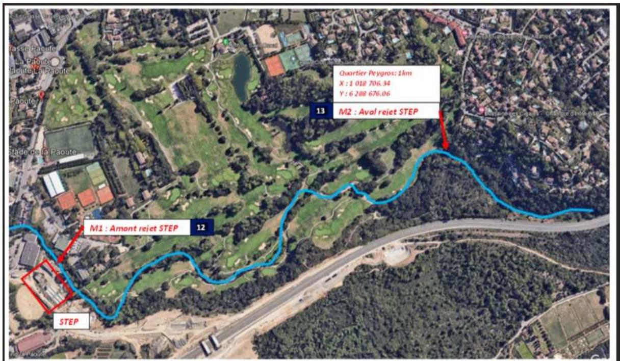
Le programme de mesures comporte les paramètres suivants : pH, température, conductivité, oxygène dissous, DCO, MES, DBO5, NTK , NO3, NH4, PO4, P total.
